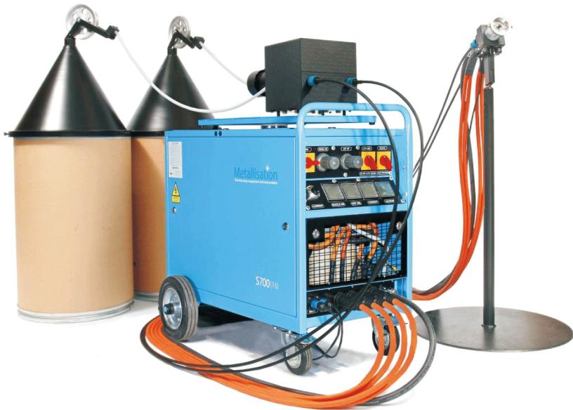
电弧丝材701-CL型喷涂系统结合优良特性与创新独特于一体。集电弧丝材700型喷涂系统特性和最新技术为一体。新型700A电源为大面积喷涂提供高喷涂率，缩短喷涂时间。除此之外，密封外壳中设置有一个简单PLC，严酷环境中仍可保持非常可靠闭路电流控制。驱动装置也更稳固，确保了恶劣工作条件下高可靠性。手持喷枪质轻，结合美特金专有技术，包括专有不变形喷枪，确保涂层质量平滑一致，且使停工时间在转换丝材时最小化。系统有多种包装选择，包括推丝主机，使电源与喷枪喷涂面积的距离最远可达25米。另外，驱动装置可放在电源上方，使其自由旋转，或在喷涂时由操作者操作。
