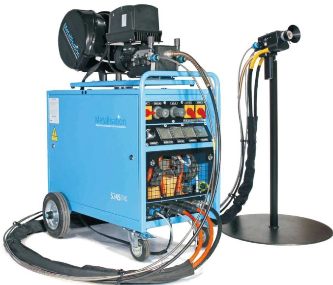
新一代电弧丝材145/S245-CL型喷涂系统为闭路电流控制，集高效与创新为一体。美特金新型电机驱动145型喷枪，灵活性好、吞吐量可控、并配有50m从电源至喷枪扩展包。
