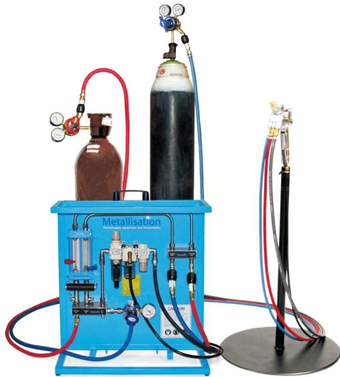
MK61 FS型火焰丝材喷涂系统是以氧气-乙炔为燃料，喷涂重量轻且喷涂效率高，用于修复中小型损坏部件。主要喷涂材料有钢、青铜、铜、钼。尤其是钼涂层制备。用MK61 FS系统喷涂钼，涂层从软粘合层逐渐变为硬质抗磨损涂层。MK61 FS系统不能以丙烷为燃料制备抗腐蚀涂层。2013新型系统配有更紧实气体燃油比和安装板。
