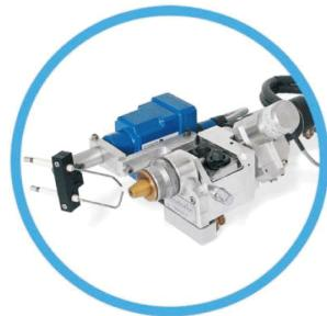
新型美特金MK66E型全自动火焰喷涂系统，配有质量流控制装置，可制备高质量重复使用涂层。系统提供全自动点火、燃烧和送丝。喷涂过程中可停止送丝，且不会融化喷嘴中、丝材，即使在扩展阶段也能实现。故障传感器可检测火焰熄灭、送丝中断或出丝，可与外部自动停止联锁，并寻求帮助。这些特点结合起来可保证操作可持续性，提高涂层质量，缩短停机时间。
